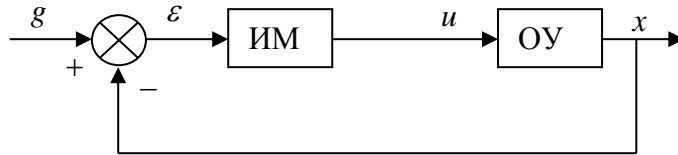
Рис. 1. Система автоматического управления.
