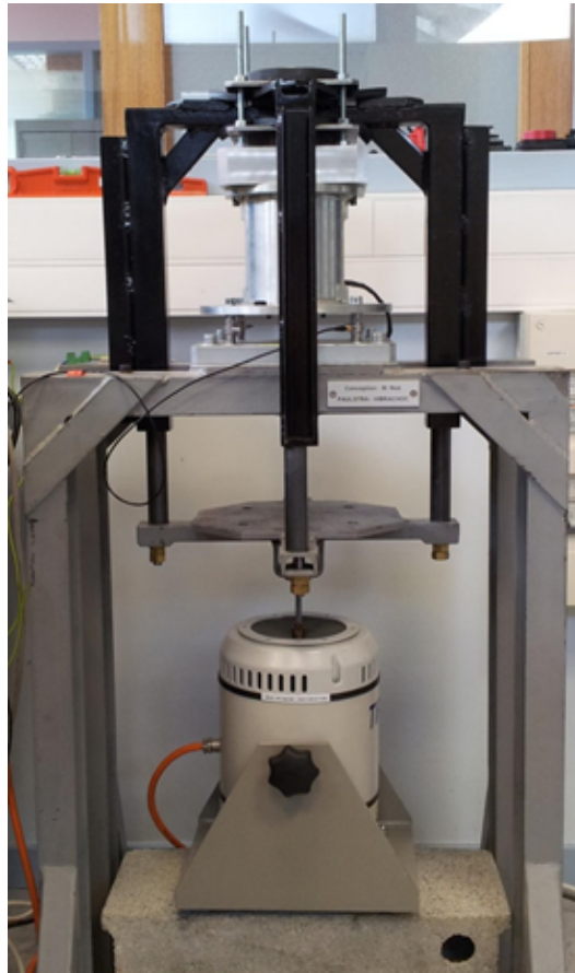
Рисунок 3.10. Стенд для проведения экспериментальных исследований по подавлению вибраций для электромеханических объектов [103], GIPSA Lab, г. Гренобль, Франция.
