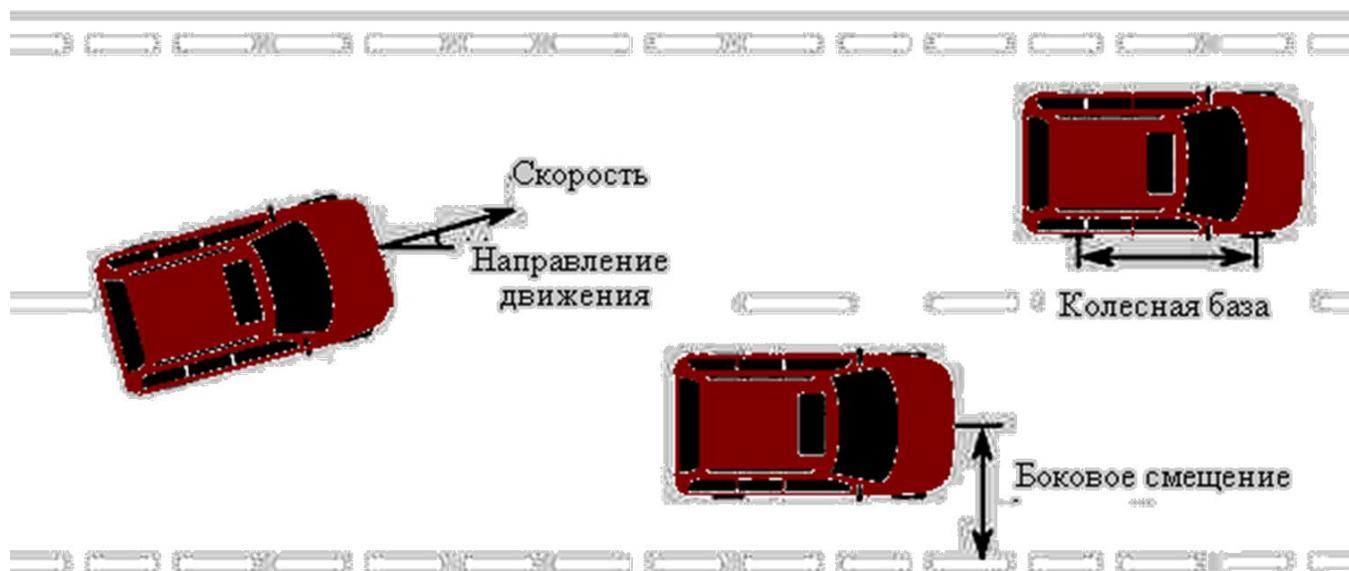
Рисунок 1.1 — Наиболее важные параметры транспортного средства: направление движения, колесная база и боковое смещение.
