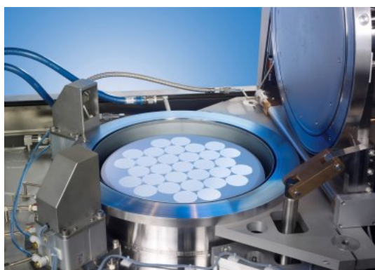
Рис. 1.4. Реактор для металлоорганической газофазной эпитаксии.
