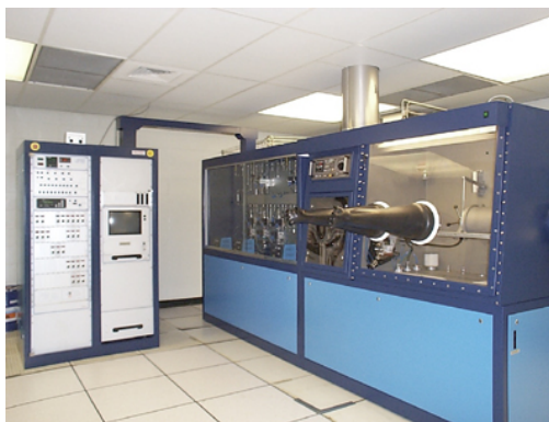
Рис. 1.7. Установка для газофазной эпитаксии из металлоорганических соединений.
