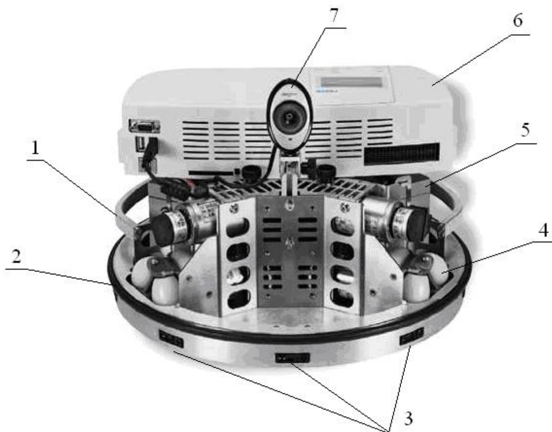
Рисунок 4.1 – Внешний вид Robotino (1 – рама, 2 – бампер для предотвращения столкновений, 3 – инфракрасные датчики, 4 – колесо с роликами, 5 – перезаряжаемые батареи, 6 – блок управления, 7 – веб-камера)
