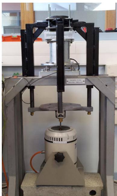
Рисунок 4 – Стенд для проведения экспериментальных исследований по подавлению вибраций для электромеханических объектов, GIPSA Lab, г. Гренобль, Франция.
