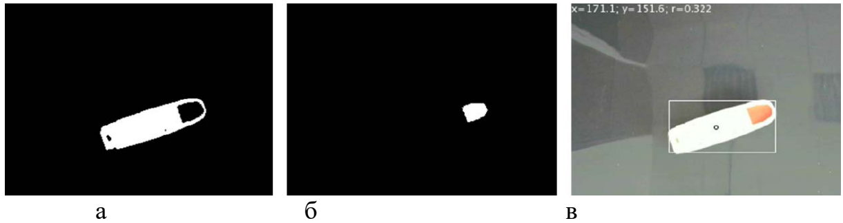
Рисунок 7 – Этапы обработки видеосигнала: создание маски корпуса (а); создание маски носовой метки (б); определение координат судна и курса (в)
